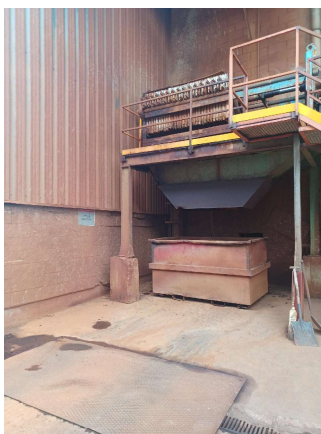
Figura 12 - Filtro prensa de las tortas de lodos de la depuradora.
