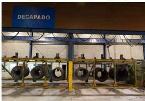
Figura 1 – Zona de carga y descarga de los rollos de acero para su posterior proceso de decapado
