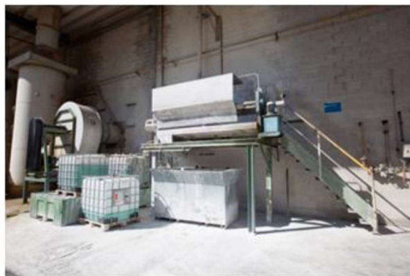
Figura 4 – Filtro prensa de tortas de lodos de fosfatado.
