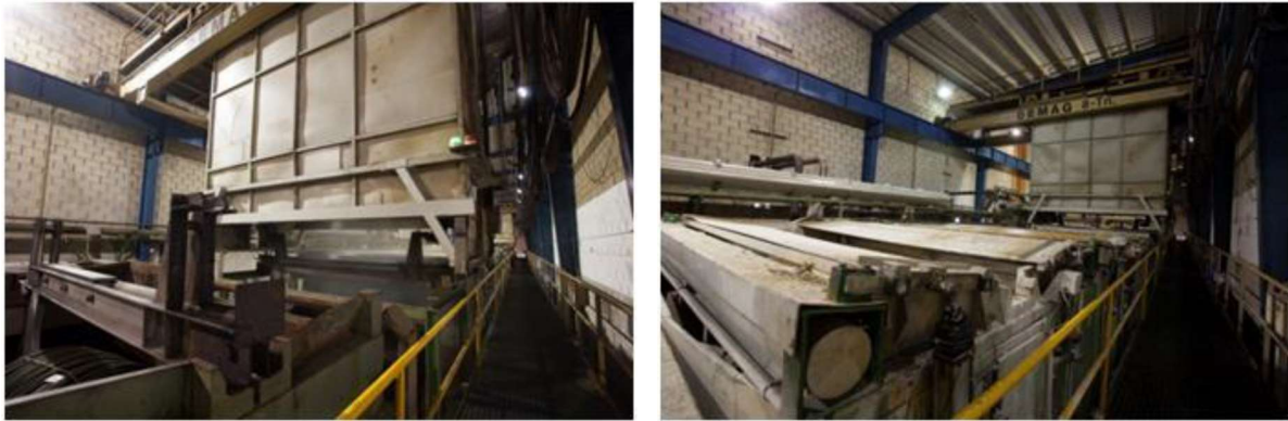
Figura 2 – Cubas y puente grúa del proceso de decapado y fosfatado
