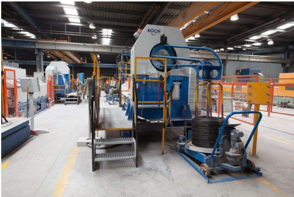
Figura 5 - Nave de trefilado y detalle de máquina trefiladora
