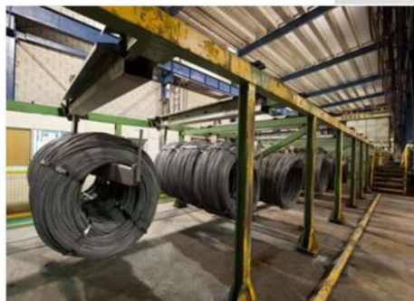
Figura 1 – Zona de carga y descarga de los rollos de acero para su posterior proceso de decapado
